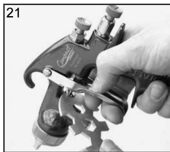
21. Ajuste la guarnición de la aguja (4) con una llave lo suficiente para hacer sello pero permitiendo que se desplace la aguja. Lubrique con aceite para pistolas.
