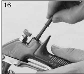
16. Vuelva a colocar el vástago (11).
